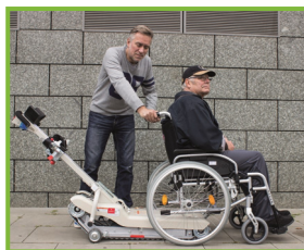
Move the wheelchair over Stairmate Rollstuhl über den Treppenkuli fahren
